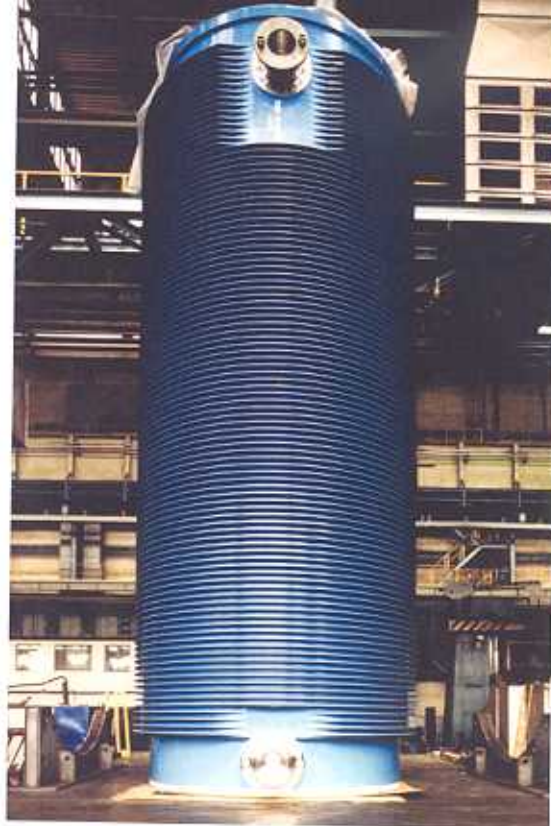
Do meziklady vyhořelého paliva v Jaderné elektrárně Dukovany dodala ŠKODA JS již 64 kontejnerů typu CASTOR®440/84.
