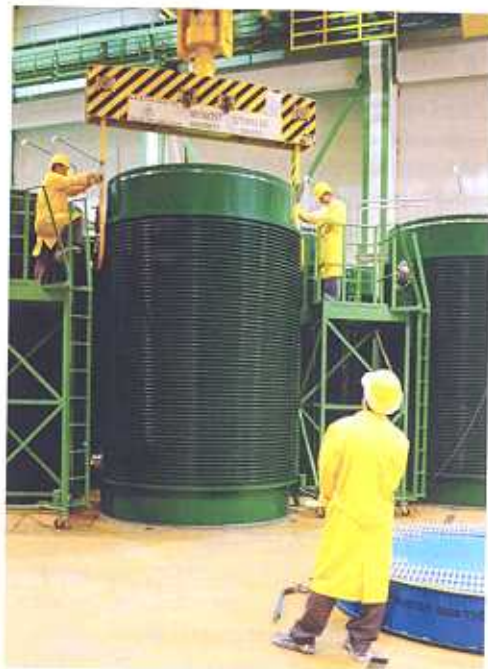
Do meziklady vyhořelého paliva v Jaderné elektrárně Dukovany dodala ŠKODA JS již 64 kontejnerů typu CASTOR®440/84.
